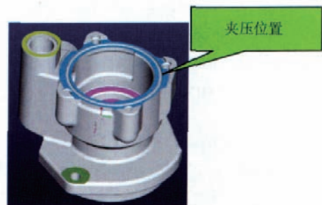
图6 夹压位置 Fig.6 Clamping position
